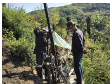
实施以浅钻代替槽探工程
