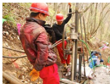
工作人员操作浅层取样钻机
